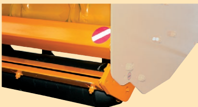
- Tylny wał o dużej średnicy (250-280) - Rear leveling roller with big diameter (250-280)
