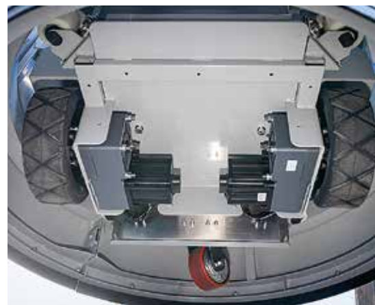
Widok od dołu: napęd Nimbo stanowią dwa silniki o mocy 400 W każdy.
