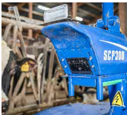
Kamera 3D zintegrowana w belce poprzecznej wykrywa przeszkody i rejestruje ilość paszy.
