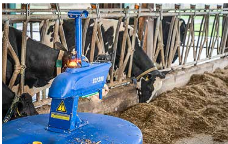
Czujniki ultradźwiękowe zamontowane u góry w składanej belce mierzą odległość od drabiny paszowej.
