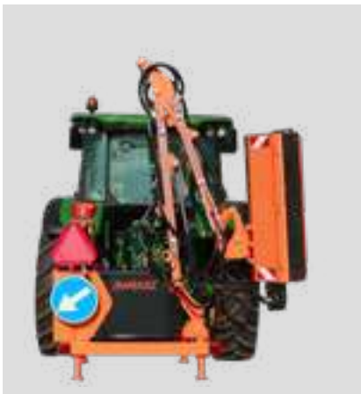
Pozycja transportowa - widoczny zderzak tylny ze światłami.
