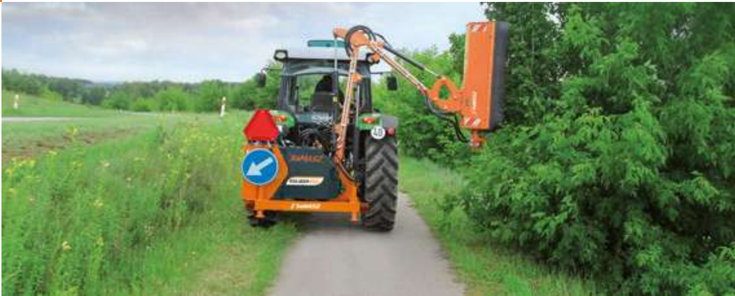
Zasięg pracy ramienia wysięgnikowego KOLIBER z głowicą koszącą LAMA 120 [cm]
