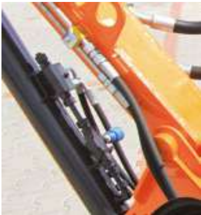
Rygiel hydrauliczny na głównym cylindrze wraz z zaworem dławiącym nastawnym.
