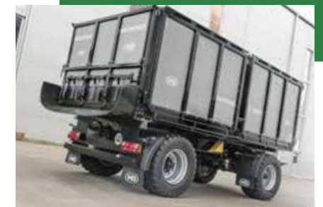
Rynna do optymalnego rozładunku wrażliwych produktów luzem (np. ziemniaków)
