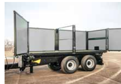
Drzwi portalowe Standardowe drzwi portalowe z lewej strony (opcjonalnie możliwe również z prawej strony), montowane uchylne
