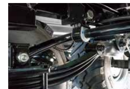
Stabilizator resorów dostępny jako opcja, zalecane do osi skrętnych
