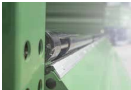
Samoczyszcząca krawędź platformy ładunkowej - ze wszystkich czterech stron
