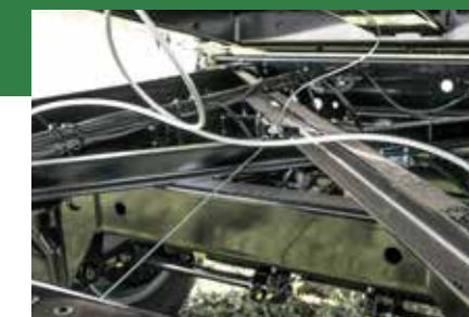
Wzmocnienie krzyżowe - zwiększona sztywność skrętna
