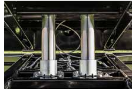
Chromowany na twardo cylinder wywrotu z przegubem jeden- lub dwa w zależności od wersji
