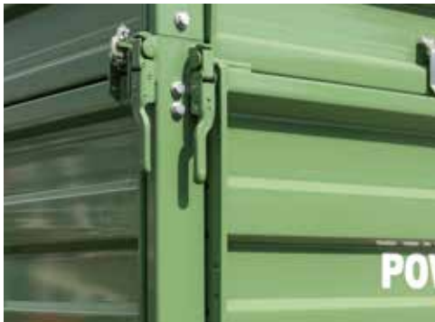
Zamki Hestál, bez wzmocnienia ściany bocznej
