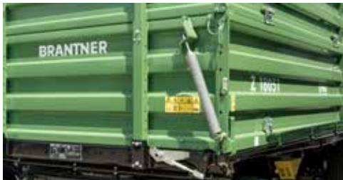
Prosta sprężyna do podnoszenia burty bocznej
