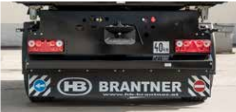
Oświetlenie Europoint II z chłapaczem przeciw błotnym na całej szerokości
