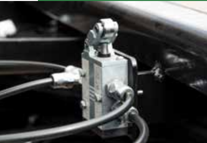
Automatyczne opuszczanie podczas wywrotu
