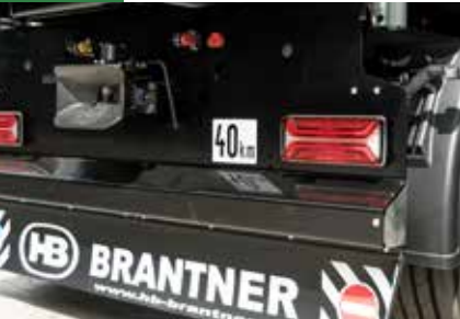
Oświetlenie w standardzie z tylnym światłem Agriled full LED z kierunkowskazami
