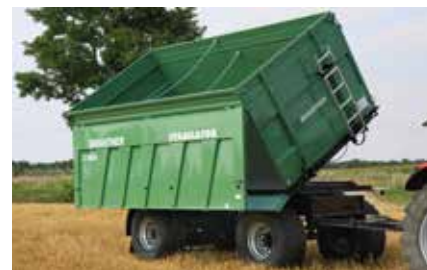
Gładkie ścianki wewnętrzne stożkowa platforma i absolutnie gładkie ścianki wewnętrzne umożliwiają łatwe zsuwanie się
