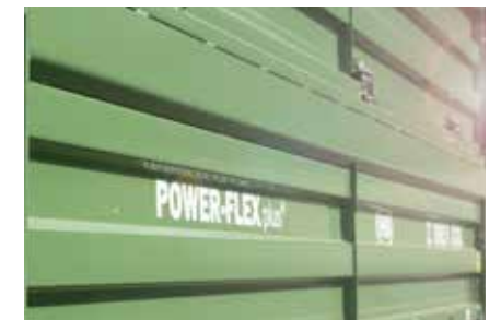
Wzmocnienia ścian bocznych z blachy stalowej 6 mm o przekroju skrzynkowym, spawane na stałe
