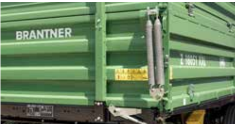
Podwójna sprężyna do podnoszenia burt bocznych, montowana dwustronnie
