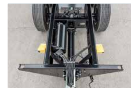
Rama prostokątna z profili tłoczonych G lub podwójnie C
