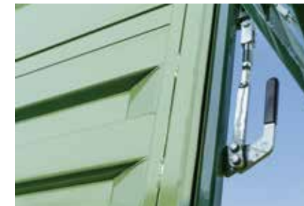
Metalowe uszczelnienie profilowane na słupku narożnym dla tylnej burty i nadstawki
