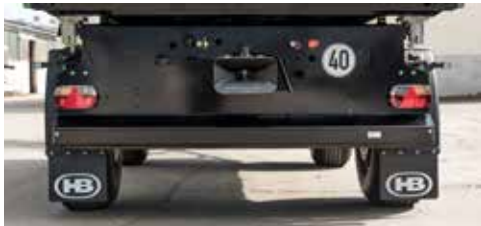
Oświetlenie wielopunktowe Multi-Point z chłapaczami na błotnikach
